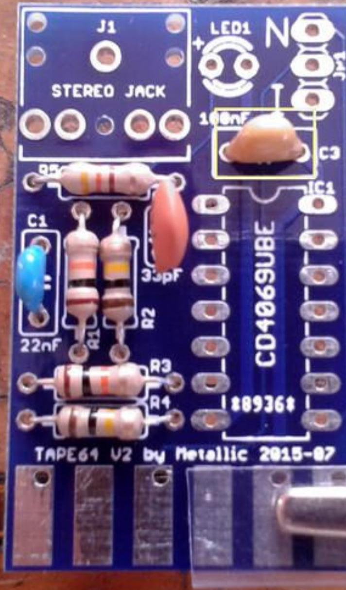
Şimdi takacağımız ledin (+) bacağını tespit etmemiz gerekiyor. Aşağıdaki fotoğraftaki ledin gövdesinde, bacaklara bağlı iki metal parça görünüyor. Küçük parçaya bağlı bacak (+)'dır (fotoğrafta soldaki). Pcb üzerinde ledin takılacağı yerdeki (+) işaretine dikkat ederek ledi pcb'ye takın ve lehimleyin.
