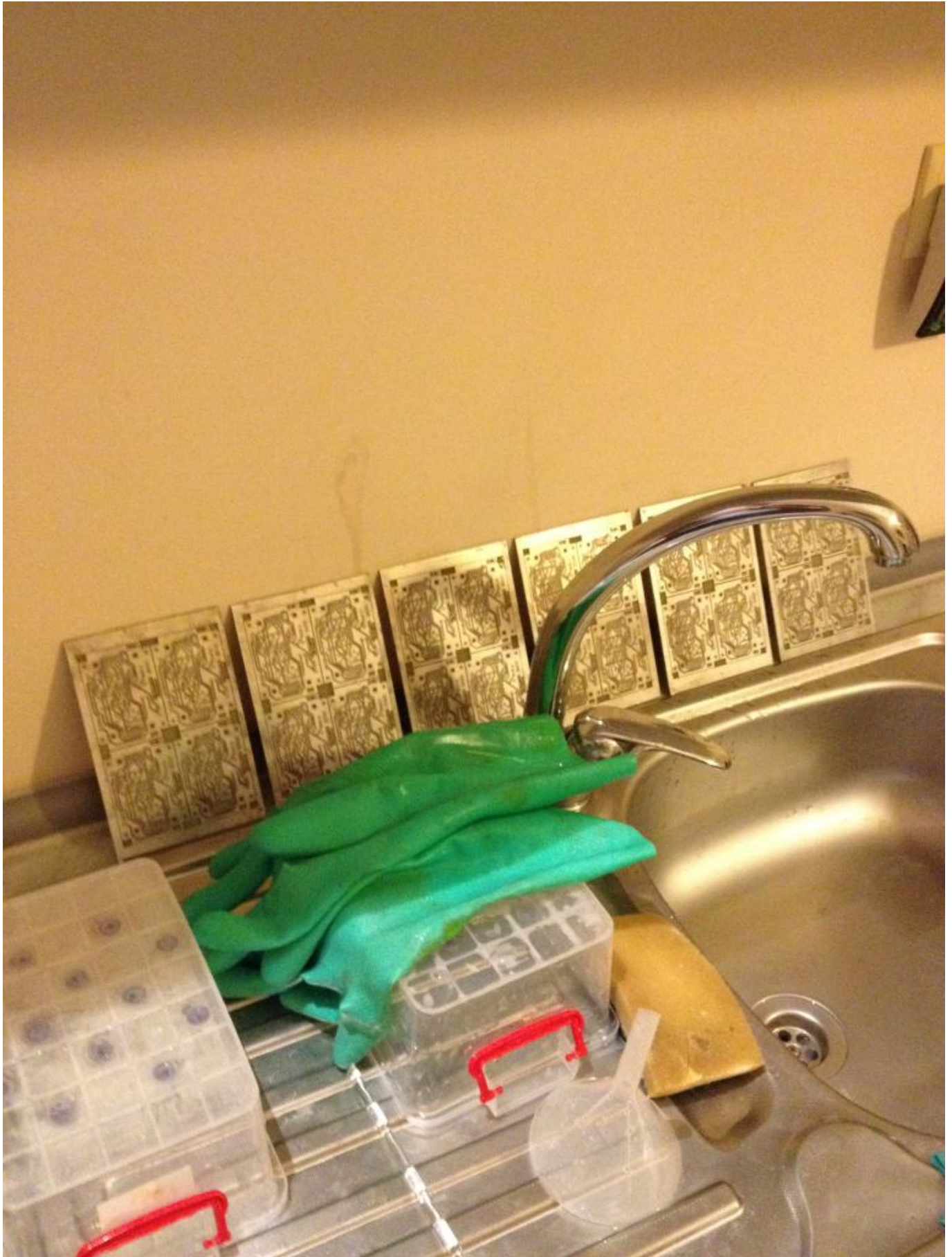
PCB'ler artık soldermask filmi ile kaplanmaya hazır...
